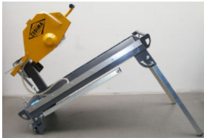
Пара опорных ножек вывернута (установка пилы) Рис. 4.8
