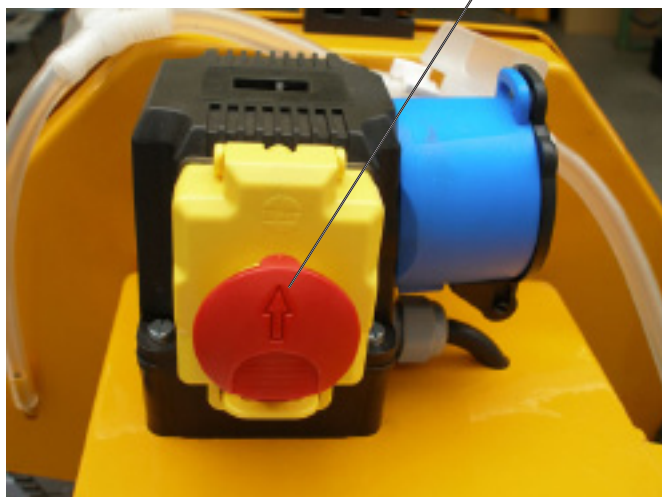
ВКЛ/ВЫКЛ, аварийный выключатель, клапан закрыт Рис. 4.40
