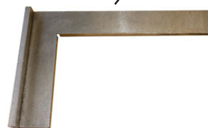
90°-уголок (вертикаль), проверка стола по диску Рис. 5.3
