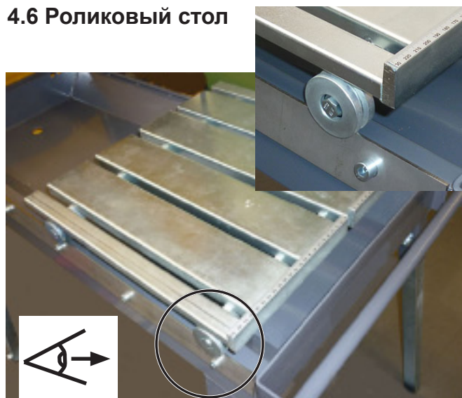
Установите роликовый стол с направляющими роликами на направляющие шины
