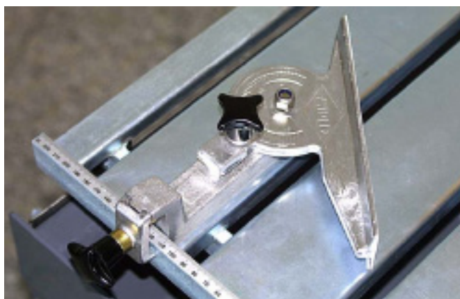
Угловой упор (зажат на упоре роликового стола)
