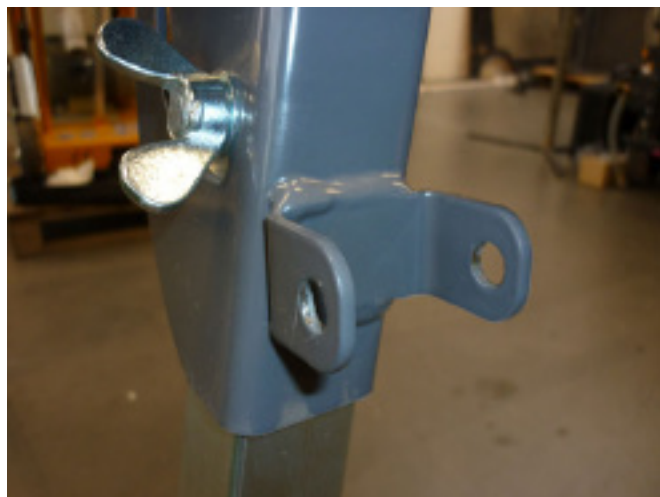
Крепление ролика на раме пилы
