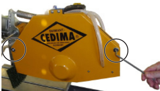
Отвинтите круглые гайки на кожухе диска
