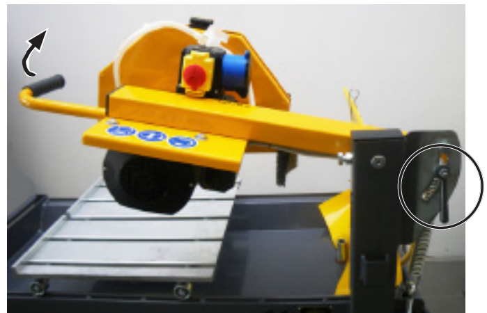
Поднимите режущий рукав и зафиксируйте зажимным рычагом
