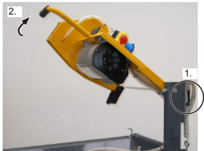
Заправьте защитный брызговик в водяную ванну Рис. 4.15
