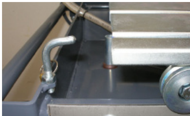
Фиксатор роликового стола смонтирован
