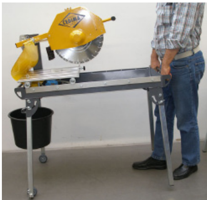
Транспортировка настольной пилы смонтированными на ножках роликами
