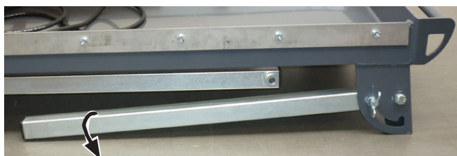
Выворачивание опорных ножек
