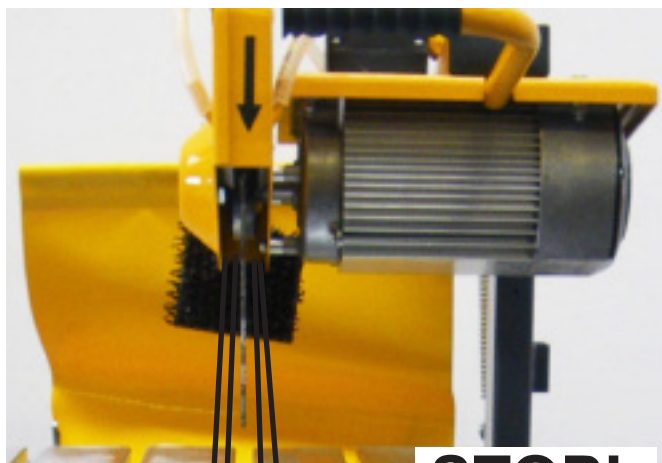
Закройте кожух диска и зафиксируйте круглыми гайками Рис. 4.32
