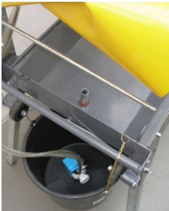
Переливная пробка в сливной отверстии в ванне, водяной насос в ведре под рамой настольной пилы
