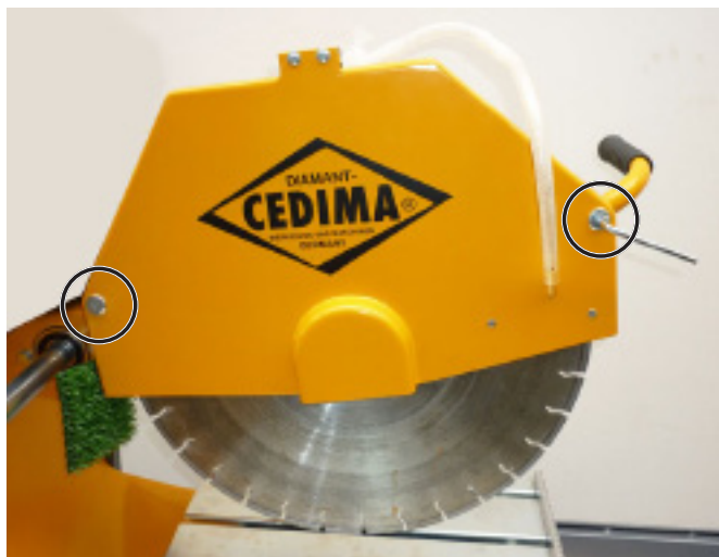
Закройте кожух диска и зафиксируйте круглыми гайками Рис. 4.32
