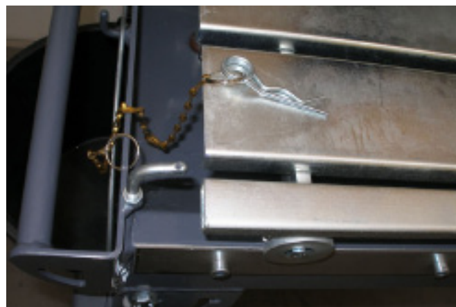
Снятие транспортного фиксатора роликового стола
