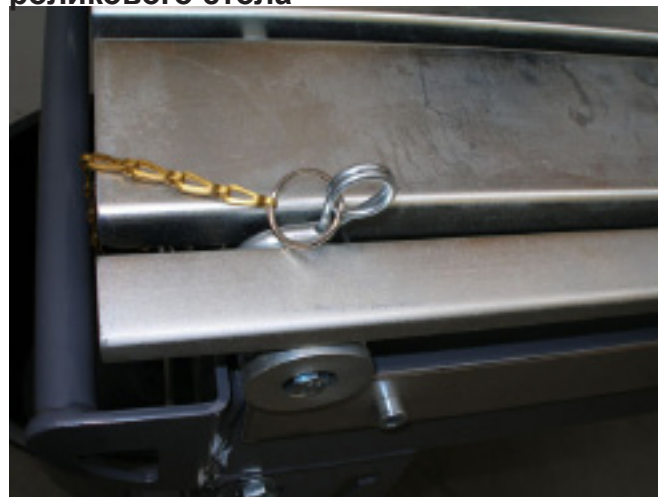
Транспортная фиксация роликового стола
