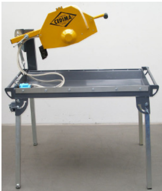
Вторая пара ножек вывернута (пила установлена) Рис. 4.11
