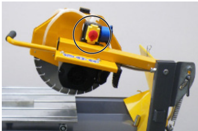
ВКЛ/ВЫКЛ, аварийный выключ., место на CTS•56
