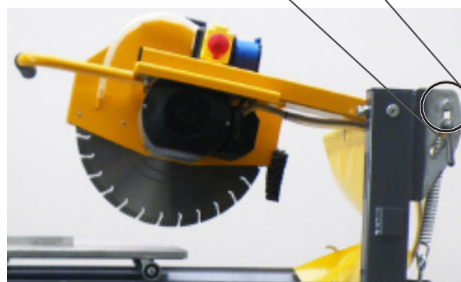
Установите ограничительный винт режущего рукава Рис. 4.36
