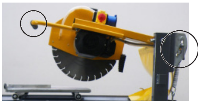
Ослабление зажимного рычага и крепления режущего рычага Рис. 4.34
