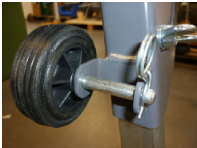
Ролик смонтирован на раме пилы
