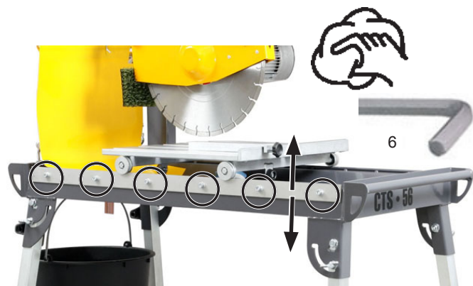
Выравнивание направляющих планок Рис. 5.2
